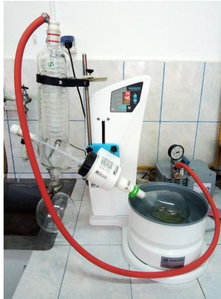
Evaporator rotativ HS-2005 V cu pompă de vid și aspecte din procesul de distilare în vid (concentrare) a alcoolului etilic din permeat
