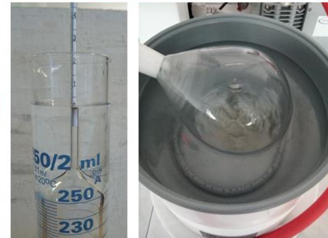
Evaporator rotativ HS-2005 V cu pompă de vid și aspecte din procesul de distilare în vid (concentrare) a alcoolului etilic din permeat
