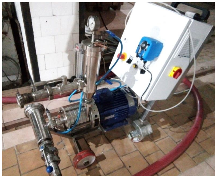
Sistemul de flotatie utilizat pentru limpezirea mustului de struguri
